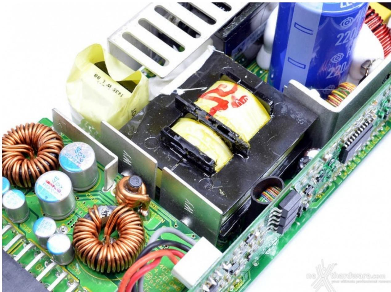
La tensione ad elevata frequenza prodotta dai transistor di switching può essere ridotta a valori compatibili con gli stadi successivi da un trasformatore di ridotte dimensioni.
