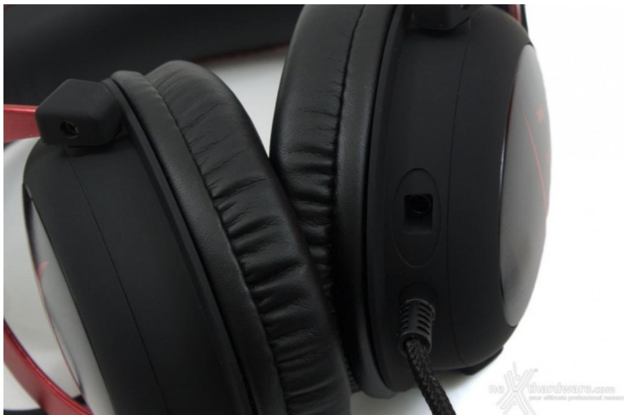
Una volta rimosso il tappo in gomma, abbiamo accesso al jack da 3.5mm che ci consente di collegare il microfono in bundle.
