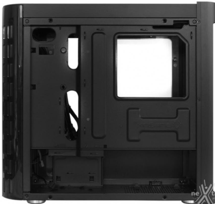
Sul lato destro del case non vi è abbastanza spazio per il passaggio di molti cavi e, a causa dello spessore
