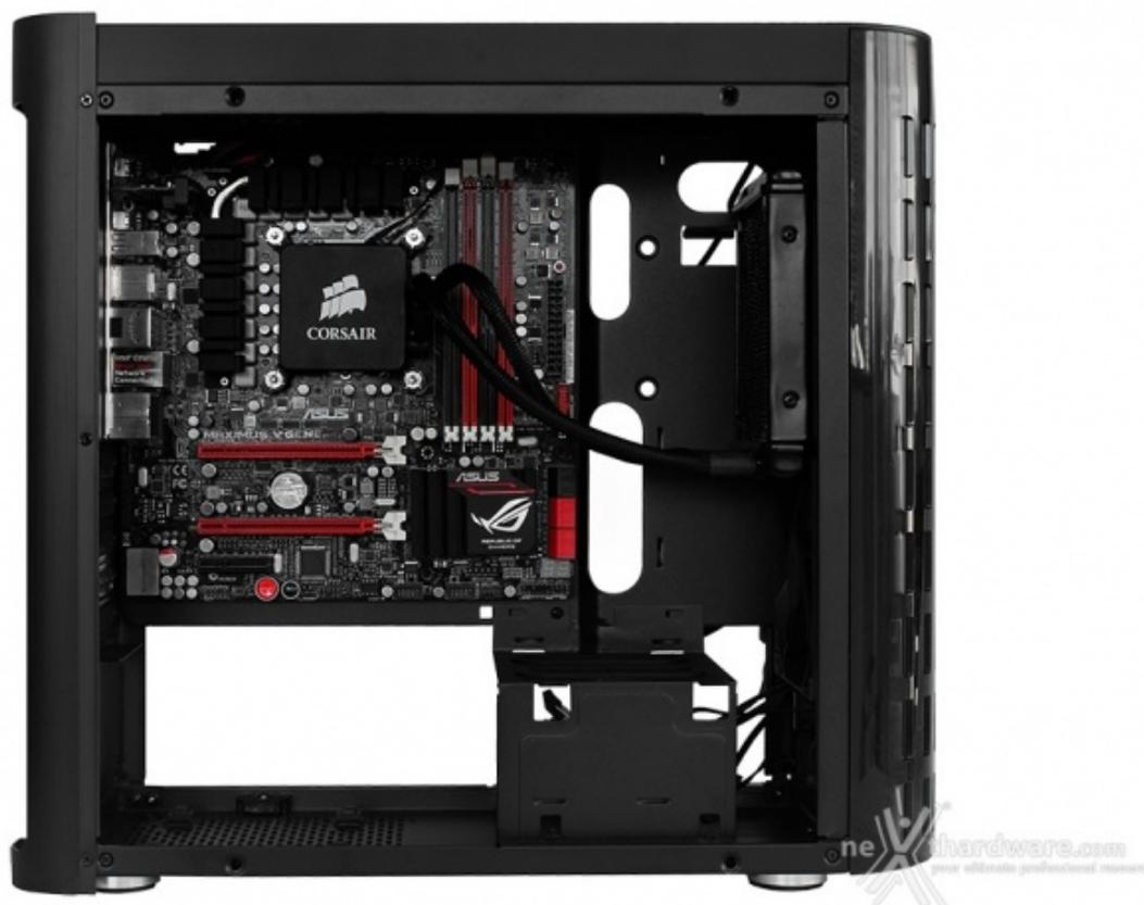
Il primo componente ad essere montato è stata la scheda madre: posizionarla è stato molto semplice e, dato che non richiede particolari accorgimenti, ve la mostriamo già con un sistema di raffreddamento a liquido integrato.
