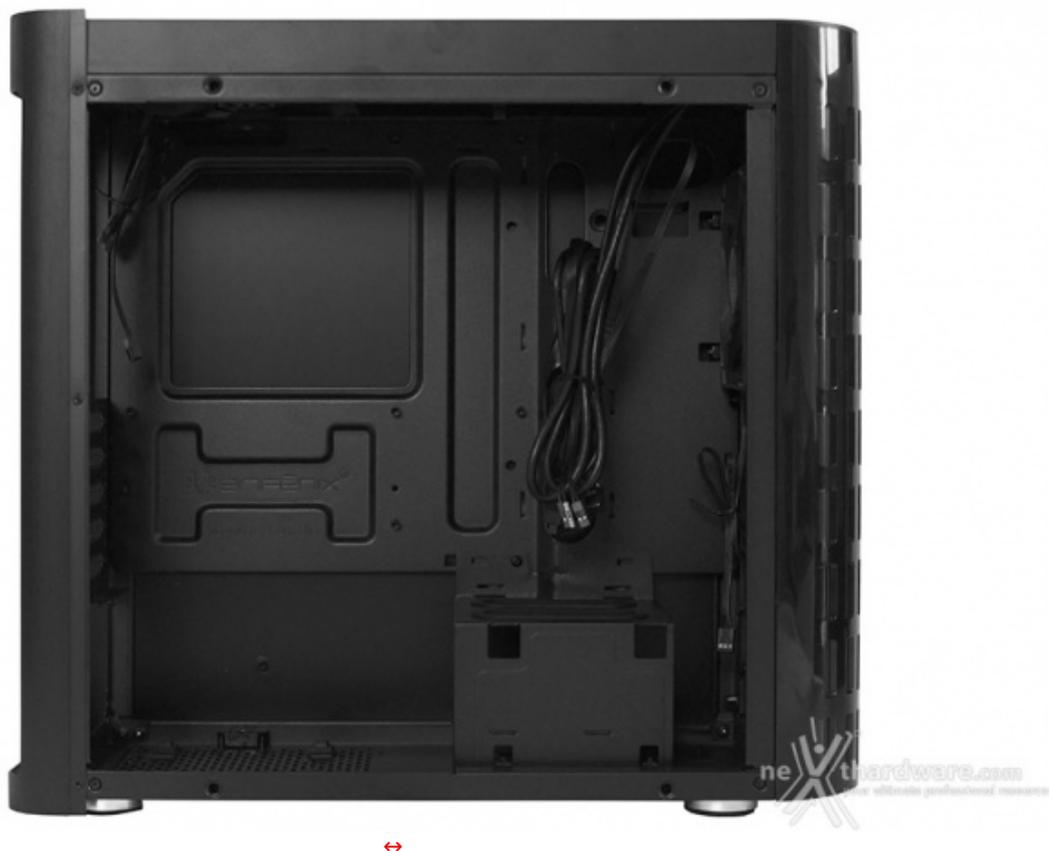
Il piatto mainboard è molto compatto e con una grande apertura in corrispondenza del socket, per favorire l'installazione e la manutenzione di un dissipatore aftermarket.
