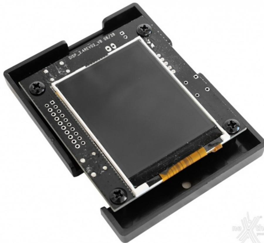
Sul lato opposto troviamo il display a colori da 2.4", di tipo TFT e con risoluzione di 240x320 pixel.
