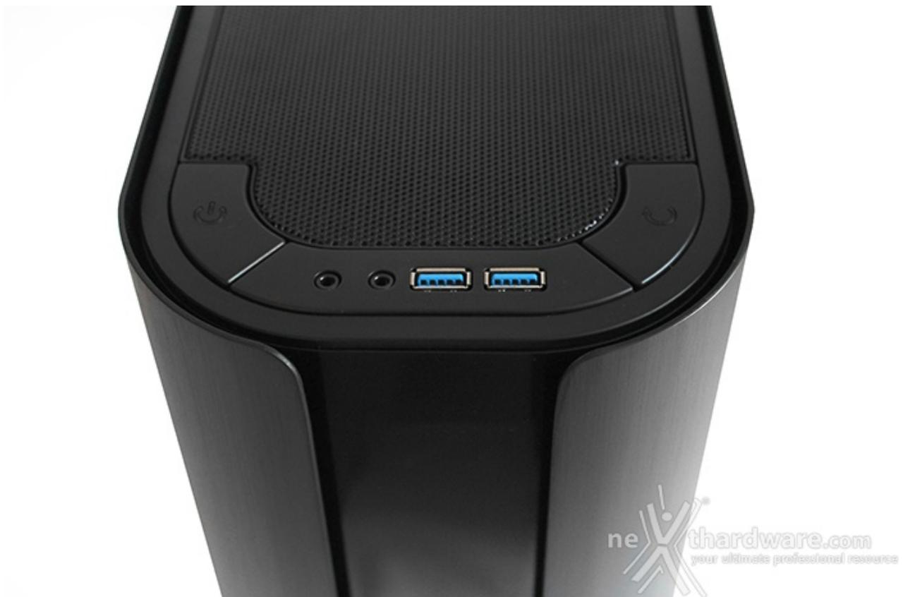
Nella parte frontale superiore è integrato il pannello di I/O, che consta di due porte USB 3.0, due connessioni HD Audio ed i pulsanti di accensione e reset dotati di LED di stato.
