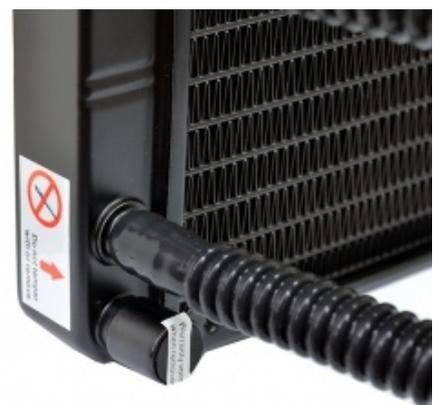
Ottima la qualità e la flessibilità dei tubi in corrugato lunghi ben 35 cm, che agevolano il flusso del liquido ed impediscono ostruzioni di sorta durante il funzionamento del sistema anche in spazi stretti.
