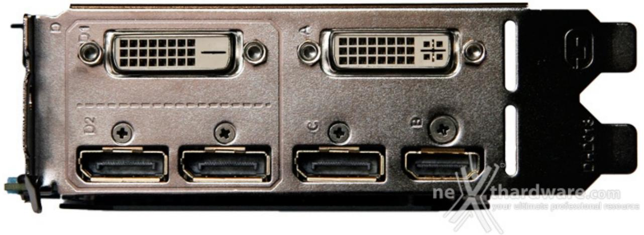
Decisamente ricca anche la dotazione di uscite video che conta tre DisplayPort 1.2 compatibili anche con lo standard eDP 1.4, una HDMI 2.0 e due DVI-DL (una I↔ e una D).
