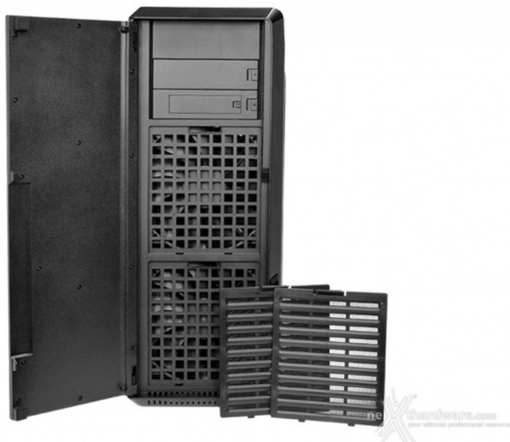
I filtri antipolvere, dotati di un robusto frame in plastica, potranno essere rimossi facilmente facendo una lieve pressione sulla clip in plastica superiore.
