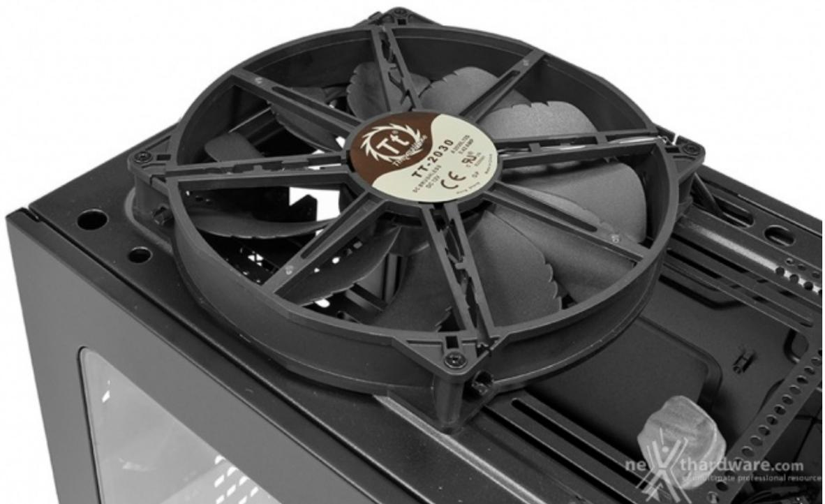
Rimuovendo l'intera copertura in plastica del top, possiamo accedere alla ventola da 200mm in dotazione, avendo così la possibilità di sostituirla con altre unità o radiatori a nostra scelta.
