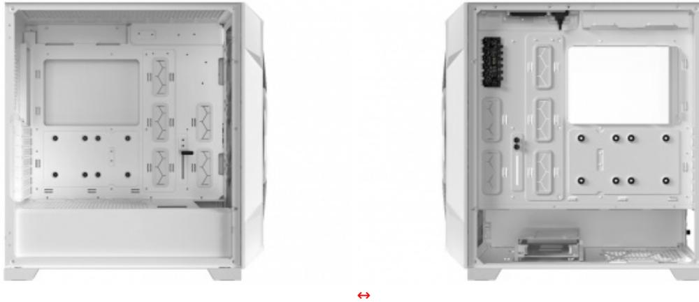
Per quanto concerne un eventuale raffreddamento a liquido, il DP505 White consente l'installazione di un radiatore da 360mm sia sul frontale che sul top e un radiatore da 120mm sul retro.
