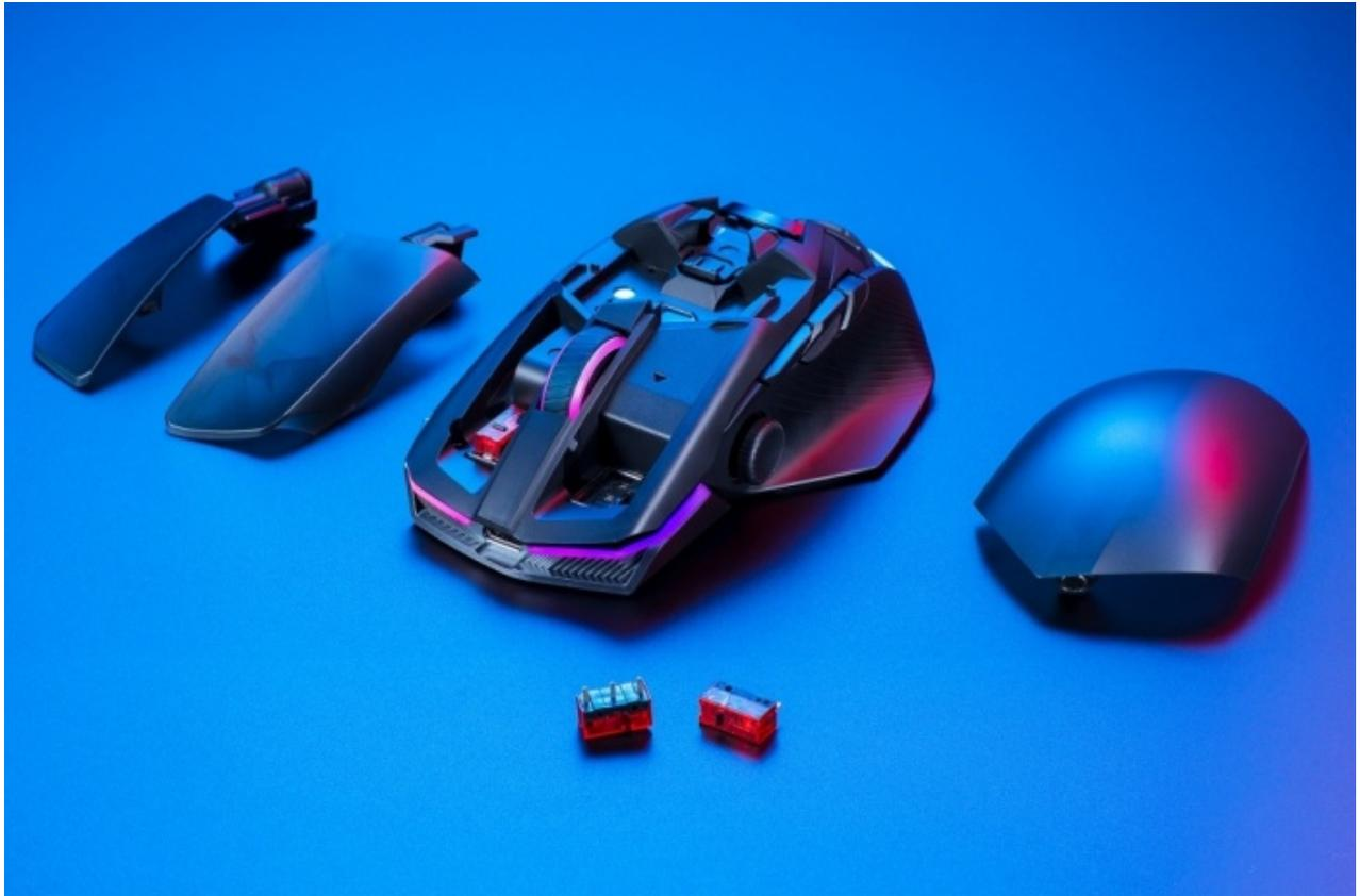
Il design aggiornato del socket Push-Fit II è ora compatibile sia con gli switch meccanici a 3 pin sia con quelli ottici a 5 pin, per permettere ai giocatori di personalizzare la forza del clic e prolungare la durata del mouse.
