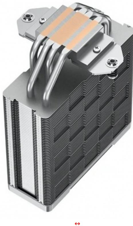
La struttura prevede la presenza di quattro heatpipes in rame a diretto contatto con la CPU ed un elevato numero di alette "ondulate" per massimizzare lo scambio termico.
