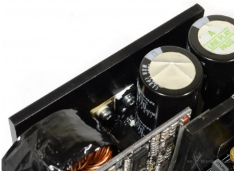
Particolare del dissipatore dedicato al controllo del fattore di potenza (APFC).
