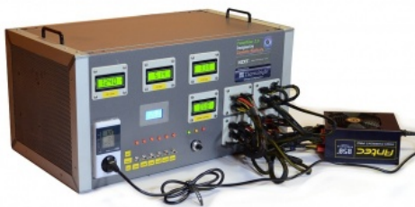
PowerKiller 2.0 Banco di test progettato per alimentatori fino a 2185W.
