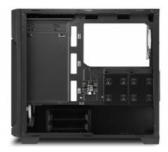
A dispetto del formato compatto, è possibile installare tre ventole da 120mm o due da 140mm sotto il pannello superiore e, al posto delle ventole montate dietro al pannello frontale, può essere installato un radiatore da 240 millimetri con uno spessore massimo, ventole incluse, di 59mm.
