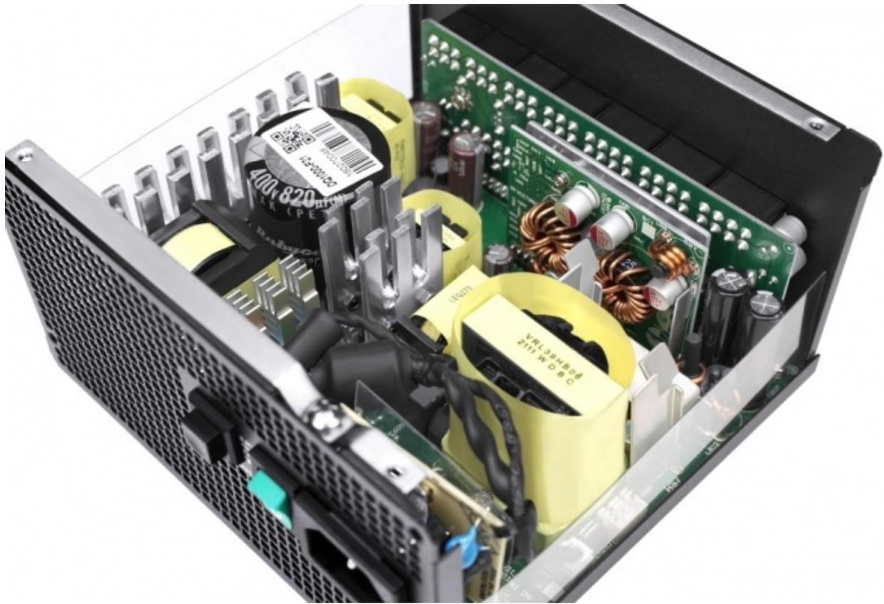
La scheda principale è rigidamente collegata alla daughterboard per le connessioni modulari, al fine di risultare un'unica struttura in grado di garantire una maggiore solidità e segnali puliti.
