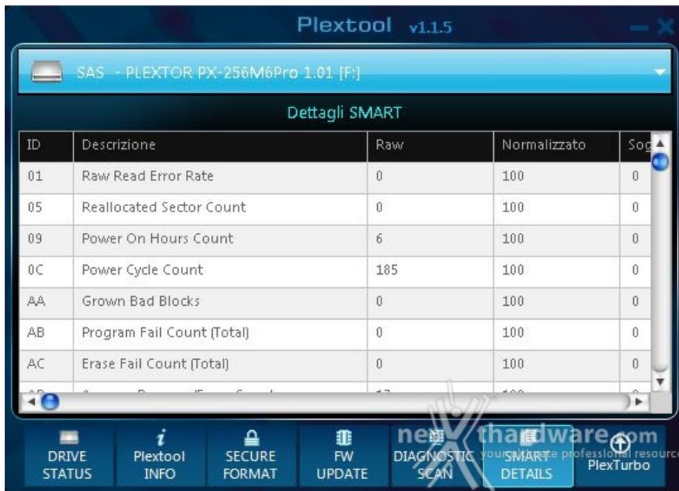
La quinta sezione permette di avere un quadro molto dettagliato e completo sulle condizioni di salute del drive, che si possono ricavare interpretando i dettagli forniti dalla tecnologia SMART mostrati a schermo.
