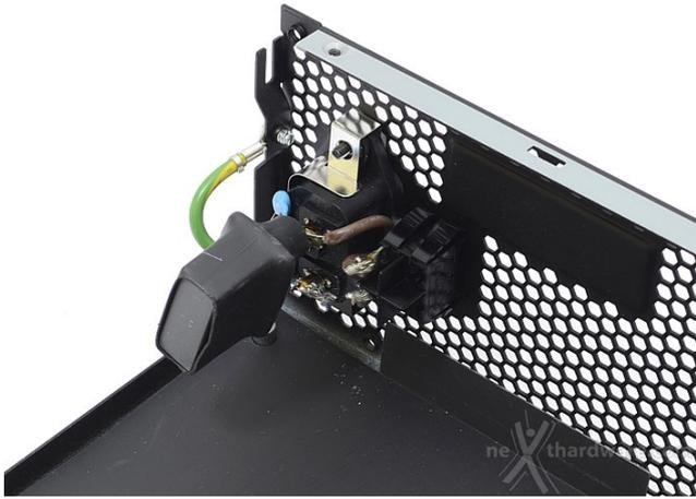
Parte del filtro EMI d'ingresso è stato ricavato ancorando tre condensatori direttamente sul retro del blocco presa/interruttore.
