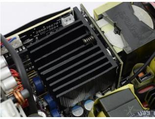
Particolare dei rettificatori d'uscita disposti sulla daughter-card e dissipati mediante un generoso elemento in alluminio.
