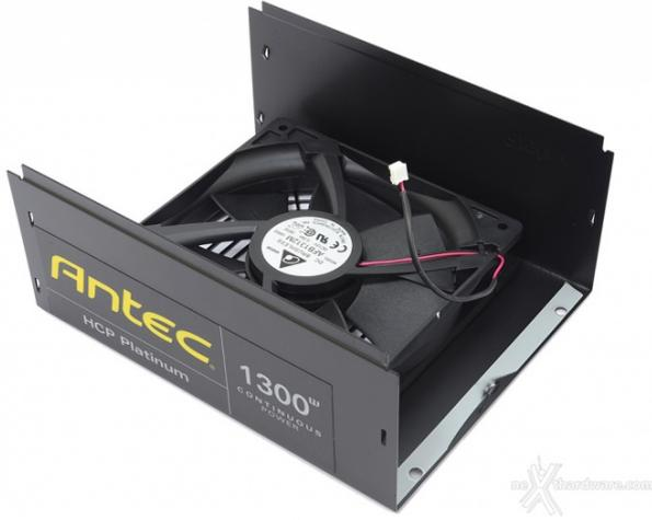
La ventola utilizzata da Antec per il potente HCP-Platinum 1300 è prodotta da Delta Electronics e, dal momento che è dotata di un sistema di sospensione a sfera con un assorbimento massimo di 0,38A, garantisce prestazioni di tutto rispetto.
