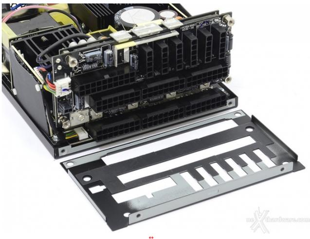
Dal momento che sul modello HCP-1300 Platinum il PCB si estende per l'intera lunghezza dello chassis, Antec ha pensato bene di rendere removibile la parte anteriore della struttura.
