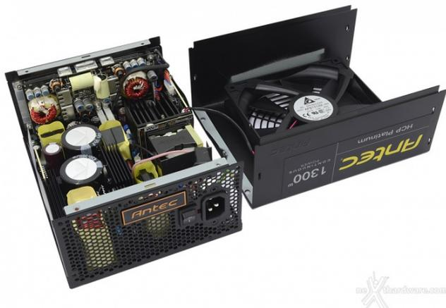
Rimosse le quattro viti che trattengono la cover superiore abbiamo modo di separare le parti e osservare la circuiteria interna.
