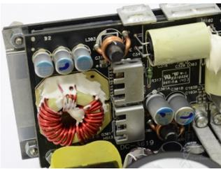
Particolare del modulo DC-DC per la generazione delle tensioni da 5 e 3,3 Volt.
