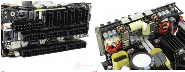
Il PCB delle connessioni modulari è a doppio strato, ossia costituito da due piastre sovrapposte.
