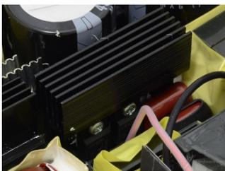
Particolare dei transistor di switching.
