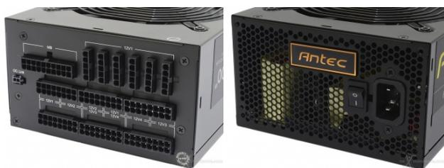
Sulla parte anteriore trovano posto i numerosi connettori del cablaggio modulare disposti su più file.
