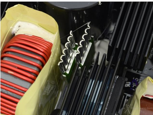
Considerata l'elevata corrente che li potrebbe attraversare nel normale funzionamento, Antec li ha saggiamente dotati di un dissipatore integrato.
