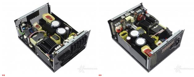
Nonostante le generose dimensioni e l'utilizzo di daughter-card (lo stesso PCB delle connessioni modulari è costituito da due schede sovrapposte), lo spazio a disposizione è completamente occupato dalla componentistica utilizzata.
