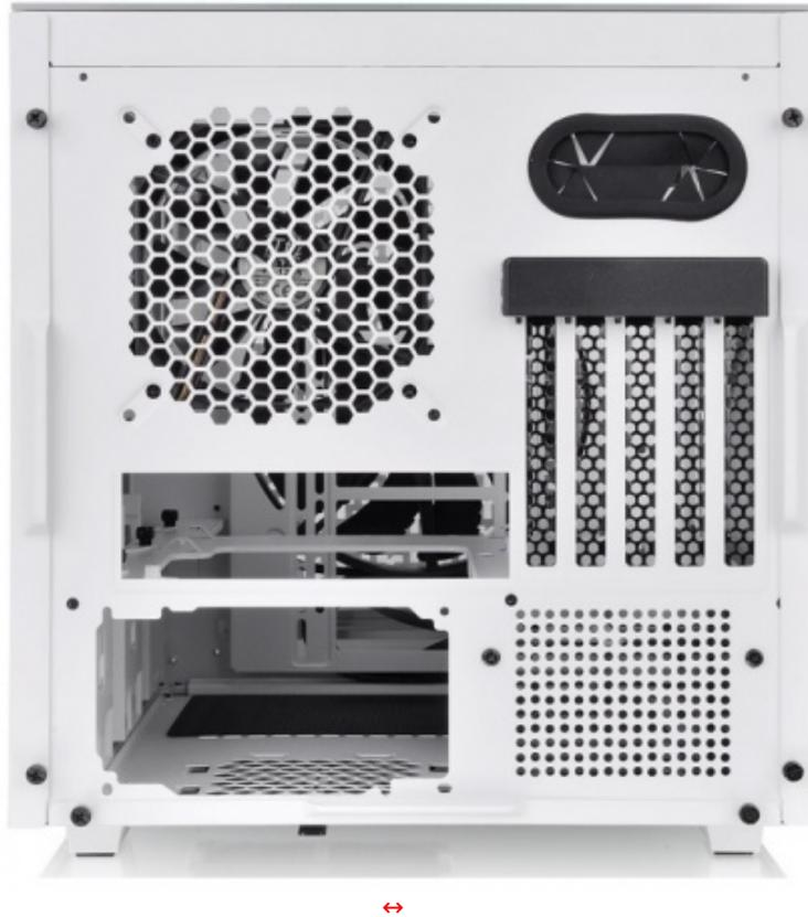
Per quanto concerne le altre caratteristiche, è possibile montare dissipatori con un'altezza massima di 185mm, schede video lunghe sino a 340mm, un alimentatore ATX da 200mm ed un totale di sei drive (tre HDD da 3,5" e tre SSD da 2,5").
