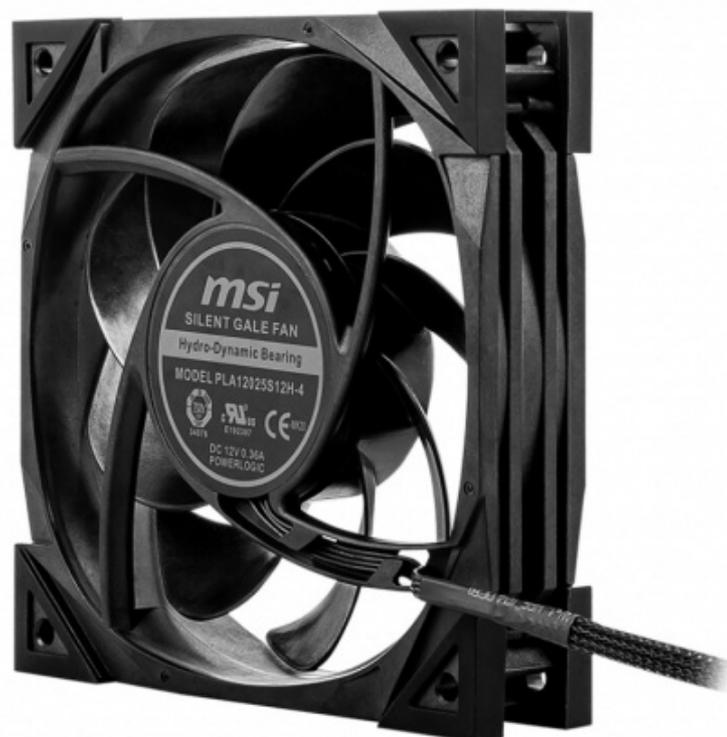
Le MEG SILENT GALE P12 hanno dimensioni di 120x120x27,5mm, un regime di rotazione massimo di 2000 RPM, un flusso di aria di 56,2 CFM, una pressione statica pari a 2,21 mm-H<sub>2</sub>O ed una rumorosità sino a 22,7 dBA.
