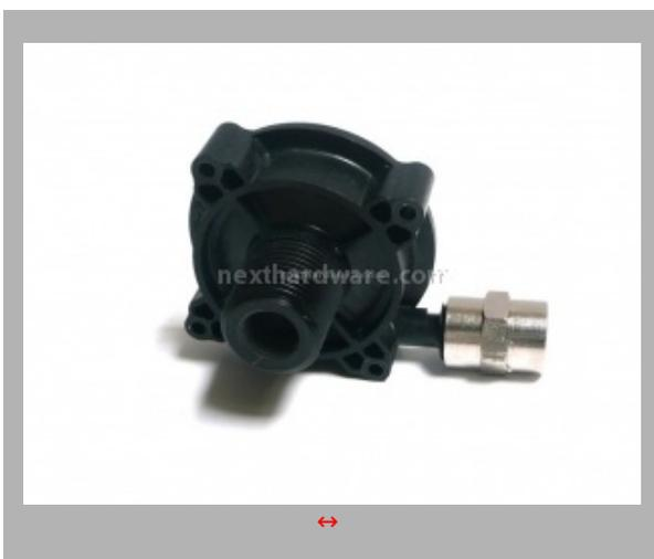
Particolare della parte esterna del top. Si può notare il raccordo in ingresso con doppia filettatura 1/2" maschio e 1/4" femmina. Sul raccordo in uscita, come detto in precedenza, è possibile installare un raccordo con filetto 1/4" maschio. Il raccordo in ingresso ha un diametro interno di 10,5mm mentre quello in uscita di 5mm.
