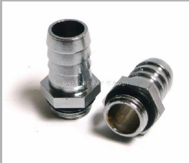
I raccordi portatubo forniti in dotazione sono i classici usati su tutti i prodotti Ybris: hanno un ID di 9,5mm e un OD massimo di circa 13mm al fine di garantire un'ottima tenuta anche con tubi da 12mm interno. Con questa pompa (date le alte pressioni in gioco) si consiglia vivamente l'utilizzo di fascette così da scongiurare eventuali perdite.
