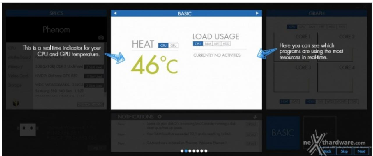
Nel layout centrale troverete un indicatore real-time delle temperature di CPU e GPU affiancate da una sorta di task manager che vi mostrerà le applicazioni in esecuzione ed il relativo utilizzo delle risorse hardware.
