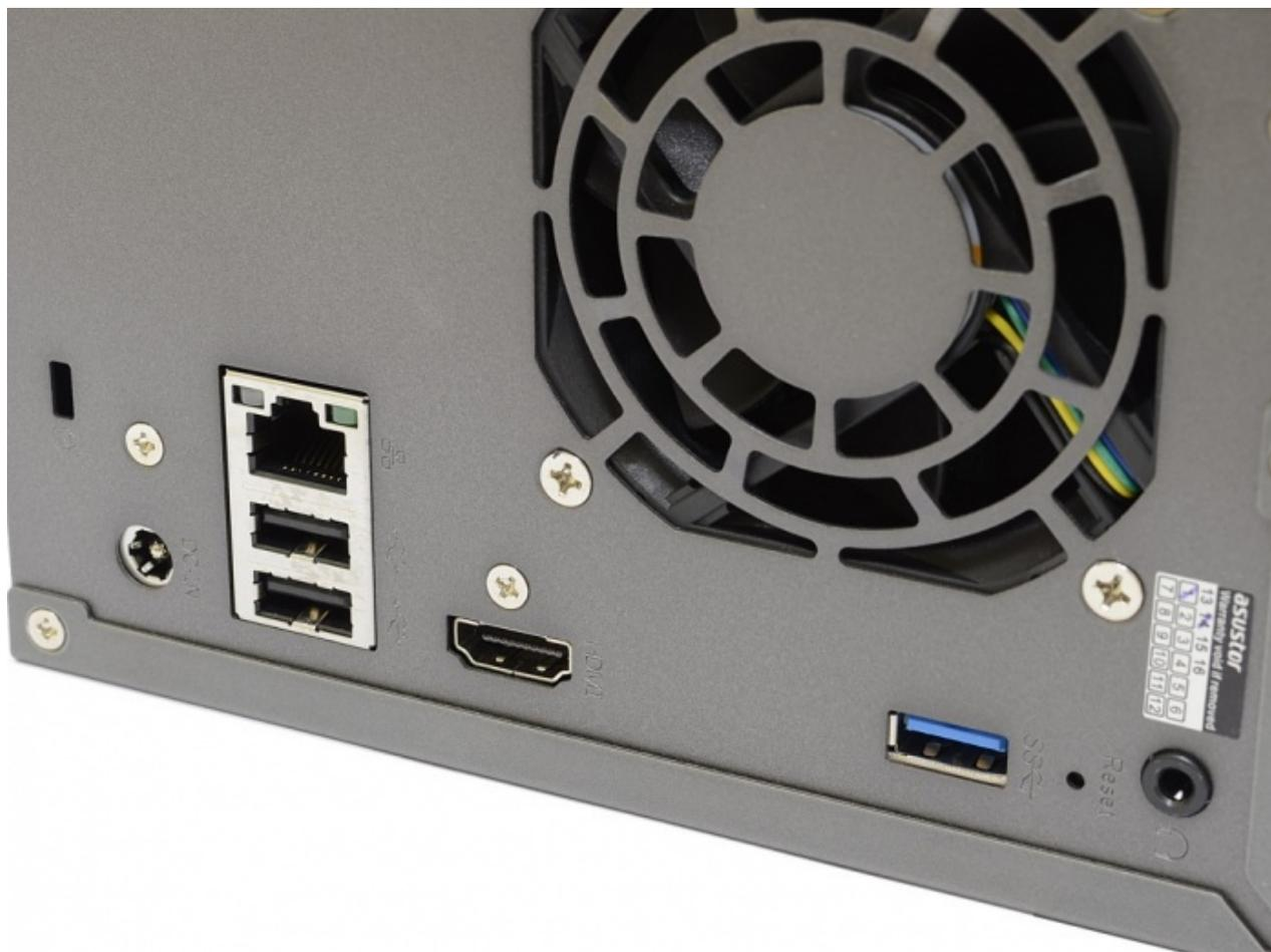
La parte posteriore, invece, è decisamente più spartana ed è dominata dalla ventola da 70mm che si occupa dell'espulsione dell'aria calda proveniente dai dischi e dall'elettronica.
