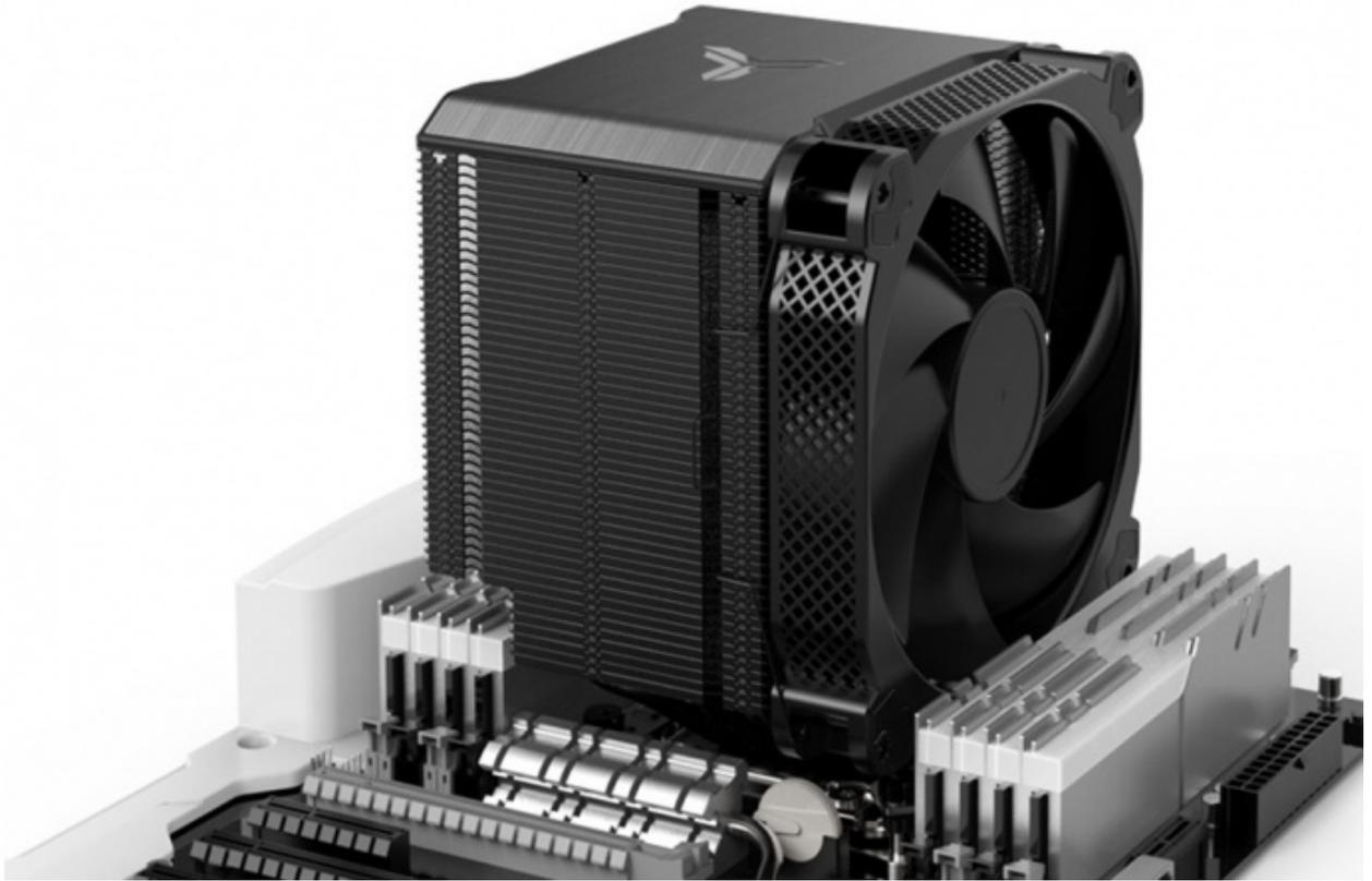
Con un peso circa 1,15kg e dimensioni pari a 121x144x162mm (PxLxA), questo dissipatore con design a singola torre single è in grado di tenere a bada CPU con un TDP sino a 250W.
