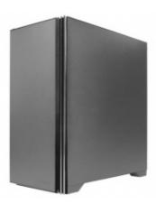
Le misure ammontano a 454x215x480mm (PxLxA) ed al suo interno possono essere installate schede madri in formato ATX, microATX e Mini-ITX, schede video sino a 380mm di lunghezza, un alimentare da 220mm ed un dissipatore con un'altezza massima da 178mm.
