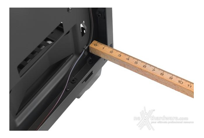
Lo spazio a disposizione per il cablaggio tra il vassoio della mainboard ed il pannello di destra è di circa 17mm nel punto più stretto, non particolarmente generoso ma più che sufficiente per ospitare un gran numero di cavi.
