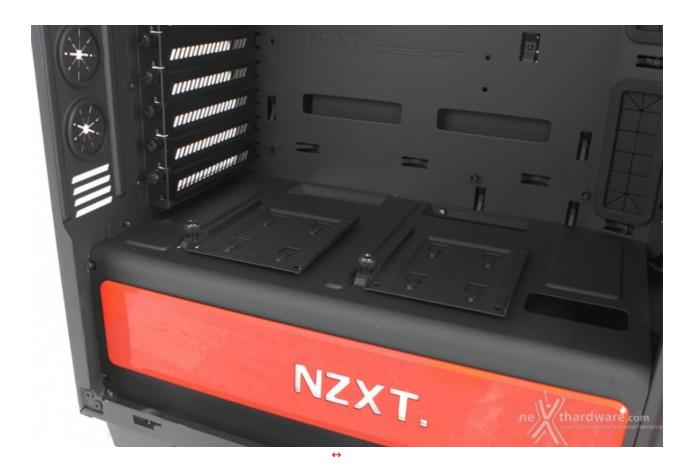
Tuttavia, NZXT ha anche previsto la possibilità di installare due unità da 2,5" sul tunnel posto a protezione dell'alimentatore.
