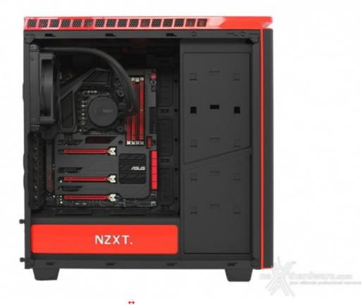
Il sistema di dissipazione può benissimo essere montato successivamente; in questo caso abbiamo utilizzato un All-in-One NZXT Kraken X40, usufruendo della ventola da 140mm posizionata sul retro del case.↔
