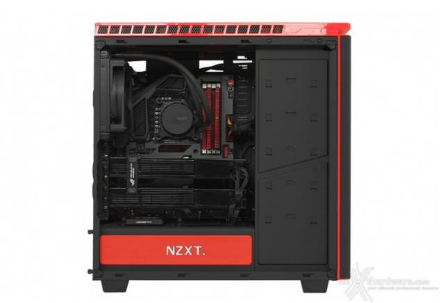
Il case non ha deluso le aspettative, il cablaggio è molto semplice da effettuare: lo spazio di manovra si è rivelato talmente ampio, infatti, da permettere l'utilizzo di un alimentatore non modulare e ben due VGA in assoluta tranquillità .
