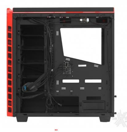
Sul lato opposto troviamo tutta una serie di accorgimenti atti a velocizzare le operazioni di assemblaggio, facilitare il cable management e migliorare il ricircolo dell'aria all'interno del case.
