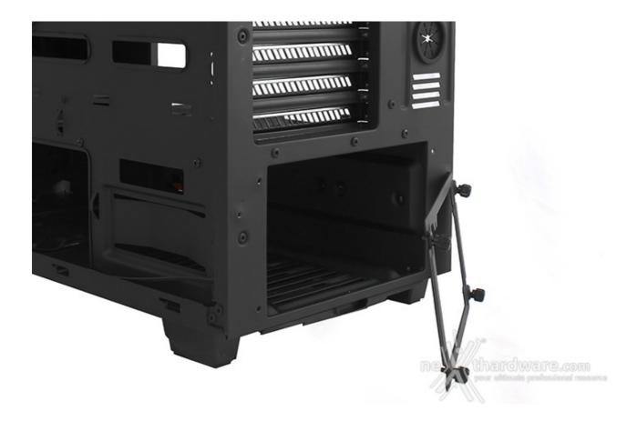
Infine, sulla base del case, vi è il vano per l'alloggiamento dell'alimentatore, dotato di frame removibile e quattro viti di tipo thumbscrew.
