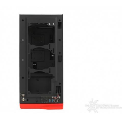
Rimosso il top si possono notare i due PCB che compongono le connessioni di I/O e le predisposizioni per tre ventole da 120mm o due da 140mm.
