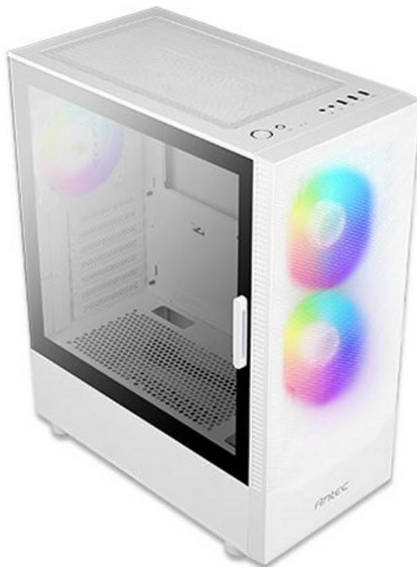
Lato connessioni, il pannello di I/O mette a disposizione, oltre ai pulsanti Power e Reset, due porte USB 2.0, una 3.0 e le classiche porte HD Audio per cuffie e microfono.
