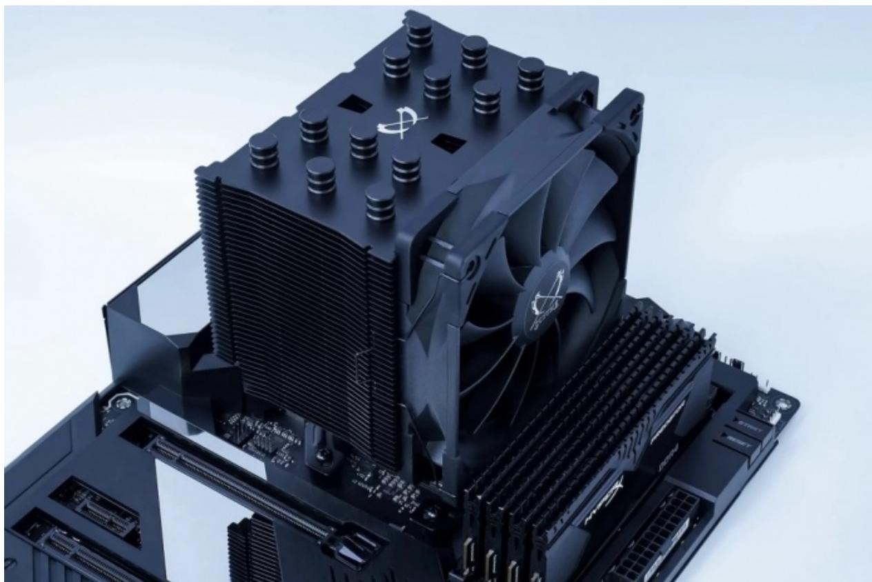
Questa nuova versione ha un peso di 890 grammi ed è completamente nera, dal corpo dissipante alla ventola Kaze Flex 120 da 1500 RPM, fino agli accessori per il montaggio.
