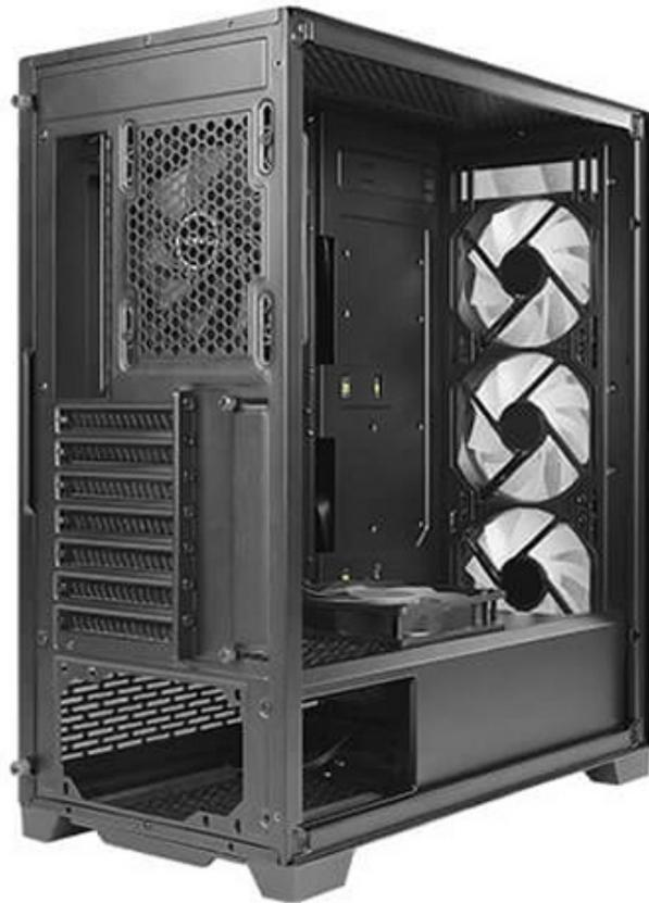
Mentre sul frontale è possibile installare in alternativa alle ventole di serie anche tre unità da 140mm, il top può ospitare tre ventole da 120mm o due da 140mm e, in entrambi i casi, è possibile montare un radiatore da 360mm, non così scontato per un case sotto i 100€,.
