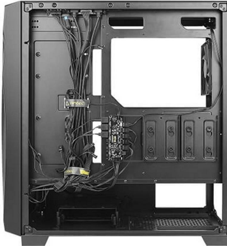
Il nuovo case può ospitare schede madri sino al formato ATX, tre SSD sul retro del vassoio e due HDD/SSD nel cestello posto sul fondo, schede video con lunghezza massima di 405mm, alimentatori sino a 205mm e dissipatori ad aria con un'altezza massima di 175mm.
