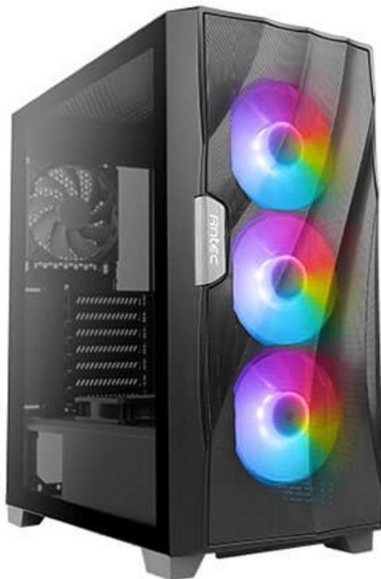
Terzo modello della gamma Flow Luxury, progettata per offrire un flusso di aria ottimale così da raffreddare i bollenti spiriti di schede video e processori di ultima generazione, il nuovo case ha dimensioni di 467x220 486mm(PxLxA) per un peso di 7,4kg ed offre di serie ben cinque ventole da 120mm di cui tre (ARGB) sul frontale, una sul posteriore ed una sul vano divisorio tra scheda madre e alimentatore.
