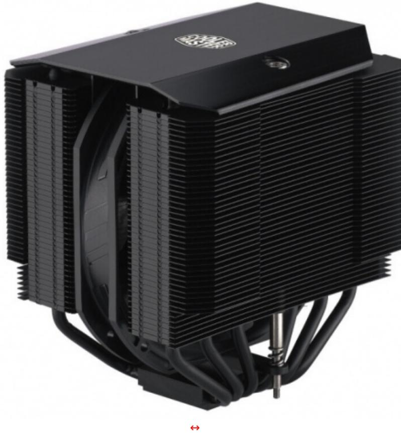
Ciascuna delle due ventole PWM da 140mm ha un regime di rotazione compreso tra i 650 ed 1.400 RPM producendo una pressione statica di 2,25 mm-H<sub>2</sub>O, un flusso di aria pari a 67 CFM ed una rumorosità ↔ massima di 27 dBA, mentre quella da 120mm ha un regime di rotazione compreso tra i 650 ed 1.800 RPM con una pressione statica di 2,50 mm-H<sub>2</sub>O, un flusso di aria pari a 62 CFM ed una rumorosità massima di 27 dBA.
