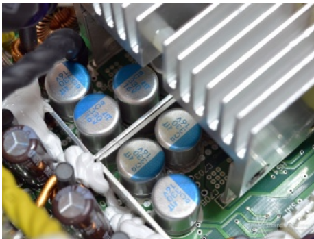
Particolare dei condensatori d'uscita e del conduttore a doppia "L" che si occupa del ritorno a massa della corrente erogata.
