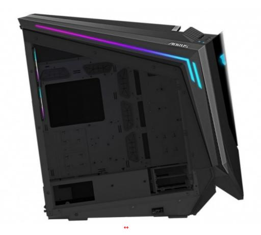
Progettato per avere un elevato numero di opzioni di espandibilità ed un sistema di raffreddamento senza compromessi, il nuovo AORUS C700 GLASS è in grado di ospitare una scheda madre E-ATX, dissipatori con un'altezza massima di 198mm, schede grafiche di qualunque tipo, dati i 490mm a disposizione, installabili anche in verticale, un alimentatore con una profondità di 200mm, radiatori da 420mm (sul frontale e sul top), otto ventole, quattro drive da 3.5" e sei da 2,5".
