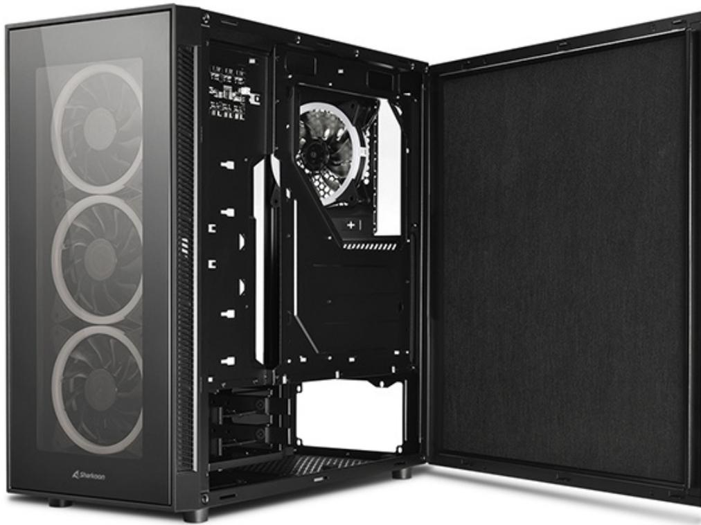
In dotazione, nascosto sul retro del piatto mainboard, è presente anche un HUB ARGB a 8 porte, di cui 4 già occupate dalle ventole presenti all'interno del case; nel caso in cui non si avesse una scheda madre con connettore 3pin compatibile, quest'ultimo potrà essere collegato al pulsante di reset che, così facendo, permetterà di scegliere tra 20 effetti di illuminazione.
