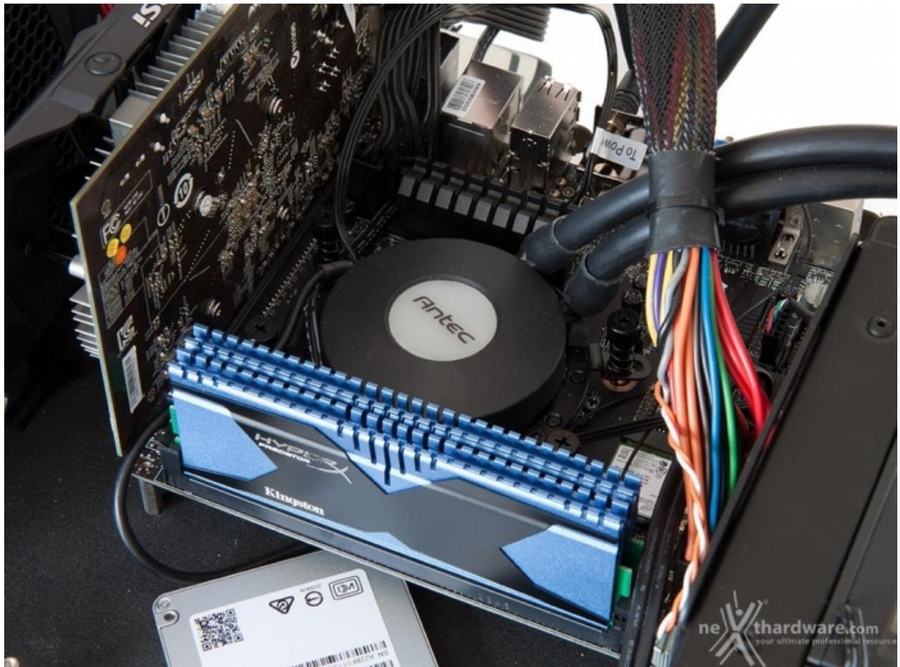
Per il raffreddamento della APU ci siamo affidati ad un sistema di raffreddamento a liquido compatto come l'Antec Kuhler 1250 che, pur non avendo le prestazioni di un impianto a liquido di tipo tradizionale, è in grado di svolgere in maniera egregia il suo lavoro, fornendo prestazioni simili a quelle di un dissipatore ad aria di alto livello.
