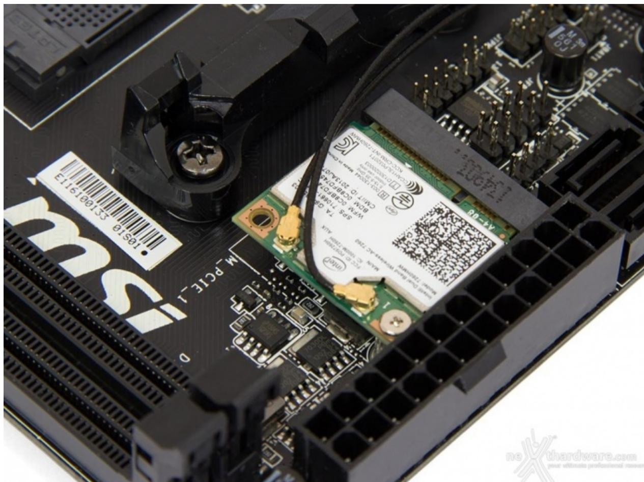
Nelle immediate vicinanze del connettore di alimentazione ATX possiamo osservare lo slot↔ Mini-PCIe occupato dal modulo Intel Wireless-AC 7260 Wi-Fi/Bluetooth.
