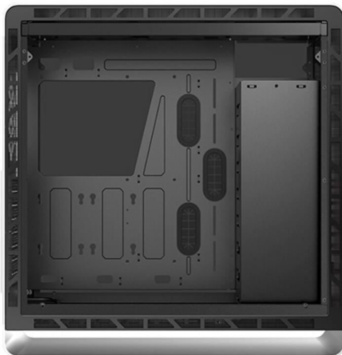
All'interno del solido case, realizzato in acciaio e alluminio e con dimensioni di 224x482x501mm (LxPxA), può essere montata una scheda madre in formato E-ATX o inferiore, schede video lunghe 330mm, due drive da 3,5" più altri quattro da 2,5" ed un dissipatore per CPU alto 169mm.
