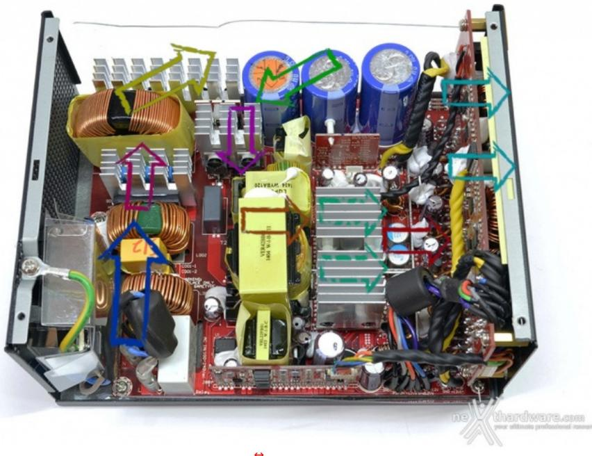
Il percorso seguito dalla corrente è piuttosto lineare; la disposizione dei componenti facilita le connessioni tra gli stessi, evitando l'utilizzo di collegamenti esterni al PCB e lasciando, al contempo, sufficiente spazio per l'aerazione degli stessi.
