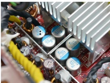
Particolare della sezione di filtraggio con elementi allo stato solido.
