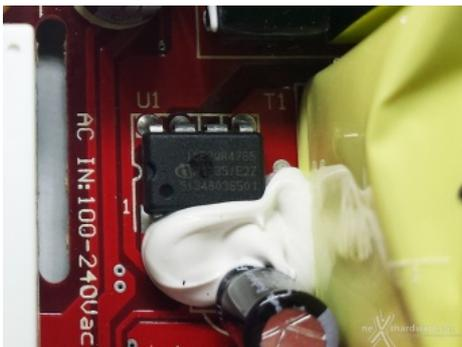
Particolare del controller PWM per la tensione di stand-by (5Vsb).
