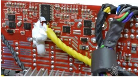
Un primo piano del circuito DC-DC per la generazione delle tensioni da 5 e 3,3 Volt.
