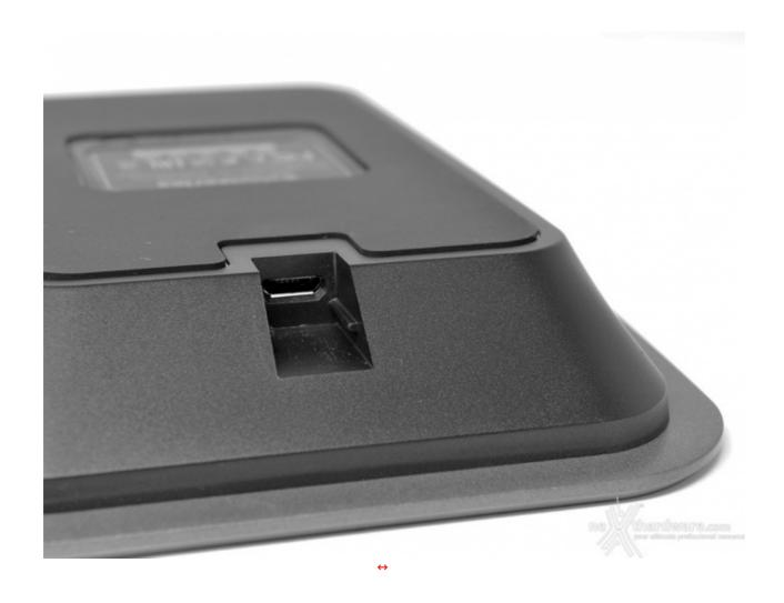
Sul retro del dock è presente l'ingresso Micro-USB per il cavo in dotazione, da utilizzare qualora decidessimo di utilizzare il mouse in modalità wired.
