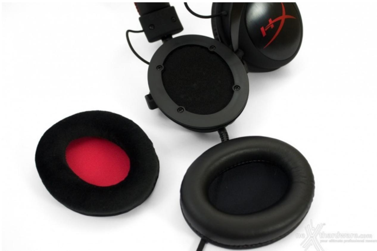
Rimuovere le imbottiture per cambiarne il modello si rivela un'operazione abbastanza rapida, applicando una moderata forza verso l'esterno fino ad estrarle completamente dai rispettivi alloggiamenti.
