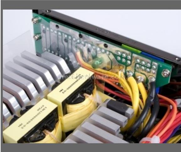
Buone le saldature nella daughterboard delle connessioni modulari. Peccato vedere i cavi terminare direttamente annegati nello stagno senza nemmeno i pin che vengono comunemente utilizzati ormai in tutti i collegamenti di questo tipo.
