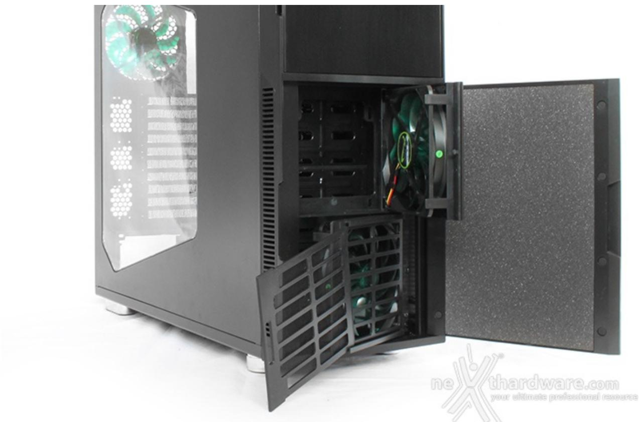
Queste ultime possono essere smontate e pulite in modo molto semplice dato che sono fissate a due filtri con sistema di sgancio rapido, facilmente sbloccabili tramite una moderata pressione in una specifica
