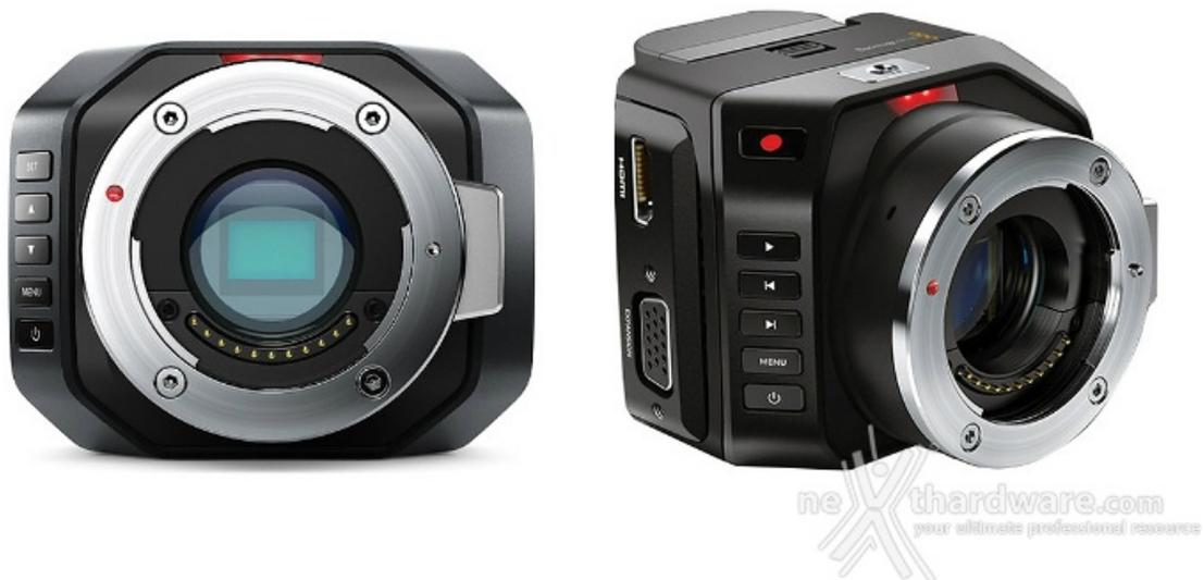
Per quanto riguarda le prestazioni è presto detto, cattura video **Full HD** con **13 stop** di gamma dinamica a **60 fps** con rolling shutter o **30 fps** con l'otturatore globale, inoltre i video possono essere catturati in **12 bit Cinema DNG RAW** oppure in **Apple ProRes**.
