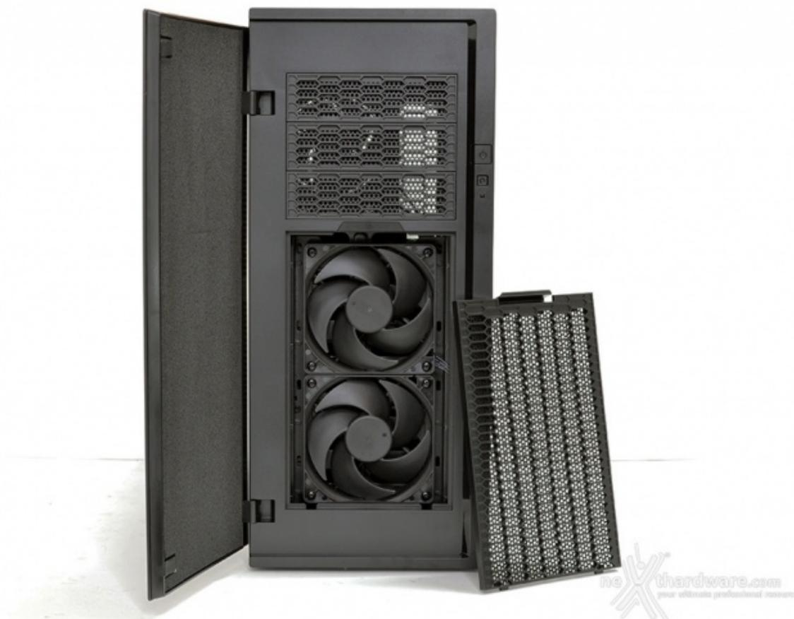
Posto a protezione delle due ventole, è presente un pratico filtro antipolvere dotato di un robusto frame in plastica.
