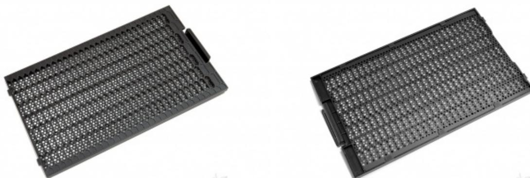
Il filtro è costituito da due superfici forate, una esterna con fori ellissoidali, che costituisce la struttura in plastica, ed una interna, che rappresenta il vero e proprio filtro, dotata di un sistema a nido d'ape a maglie molto strette in modo da bloccare efficacemente le infiltrazioni di polvere.
