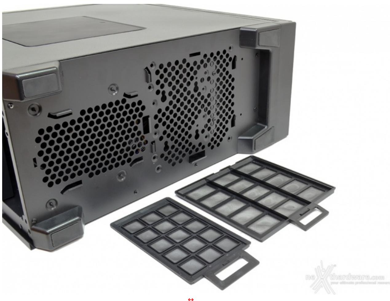
Entrambi i filtri antipolvere sono dotati di un robusto frame in plastica che ne aumenta la praticità durante l'installazione e la rimozione.
