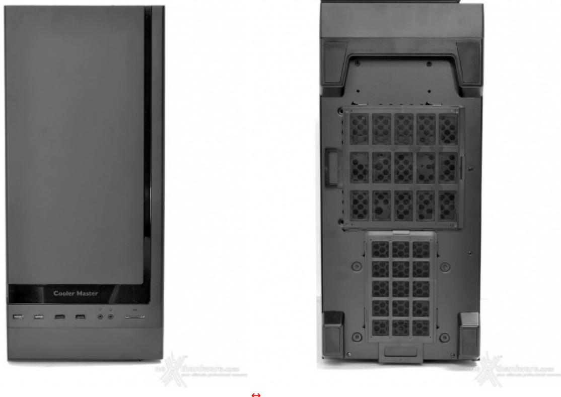
Sulla parte inferiore, invece, sono installati due filtri antipolvere per proteggere in modo efficace l'alimentatore ed un'ulteriore ventola opzionale da 120/180mm.
