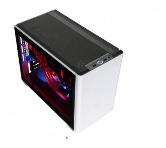
La disposizione degli spazi interni è indubbiamente frutto di un attento studio del reparto R&D consentendo un assemblaggio veloce dei componenti e, come se non bastasse, tutti i pannelli esterni e le ventole montate in alto (NR200P) prevedono un sistema di fissaggio tramite perni per una facile rimozione.
