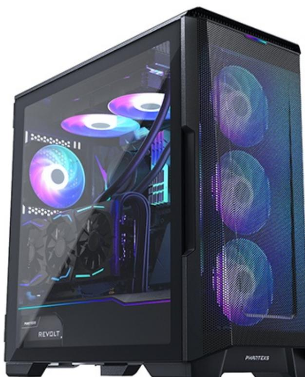
Nonostante le dimensioni nella norma per un Mid Tower, il P500A consente di montare, previo acquisto del kit Dual System di Phanteks, ben due configurazioni di cui una, con scheda madre ITX, installabile sul piano divisorio dello scomparto dedicato all'alimentatore.
