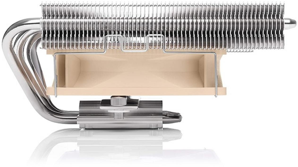
Ovviamente utilizzabile anche su altri case e compatibile con i socket Intel LGA 1200 e 115X e AMD AM4, questa "via di mezzo" tra i due modelli precedentemente citati è raffreddata attivamente da una silenziosissima ventola Noctua NF-B9 PWM da 92mm, posta al di sotto del corpo lamellare collegato direttamente alla base tramite quattro heatpipes, per uno sviluppo in verticale di 66mm, esattamente l'altezza massima consentita dal case Loque.
