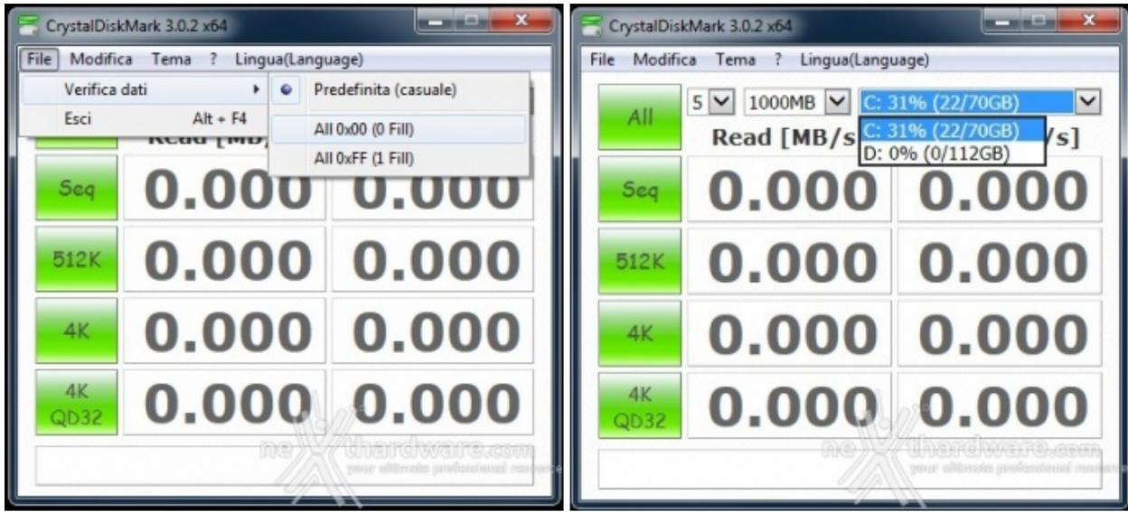
Dal menu "File -> Verifica dati" è possibile selezionare il test con dati comprimibili, scegliendo l'opzione All 0x00 (0 Fill), oppure il tradizionale test con dati incompressibili, scegliendo l'opzione Predefinita (casuale).
