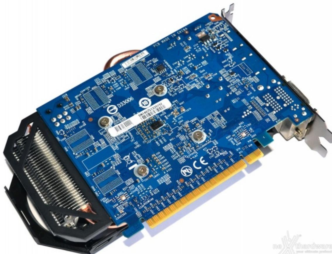
Sul retro del PCB, scervo di particolari componenti, possiamo osservare le quattro viti che garantiscono l'ancoraggio del sistema di raffreddamento, tutte poste attorno alla GPU.
