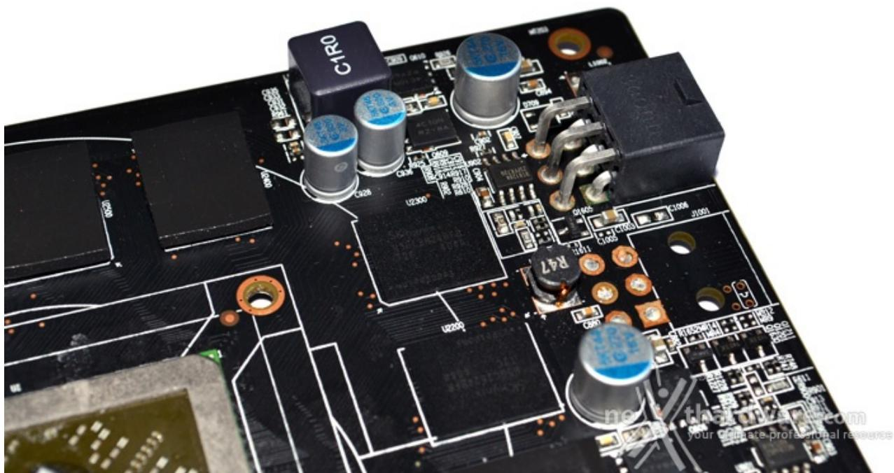
A parità di capacità, il numero dei moduli è otto rispetto ai quattro utilizzati dalla 750 Ti, perchè il BUS a 256-bit ne richiede otto per poter operare alla massima banda.
