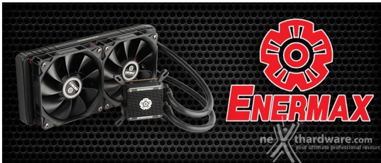
Il terzo sistema in prova è prodotto da Enermax, per la precisione il nuovo Liqtech 240, dotato di un radiatore da 240mm appositamente progettato dall'azienda taiwanese e di due ventole Twister Pressure con selettore per la regolazione degli RPM.
