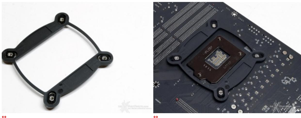
Il backplate fornito a corredo è compatibile solo con socket Intel, motivo per cui, se si dispone di socket AMD, si dovrà ricorrere necessariamente a quello incluso di serie sulla propria scheda madre.
