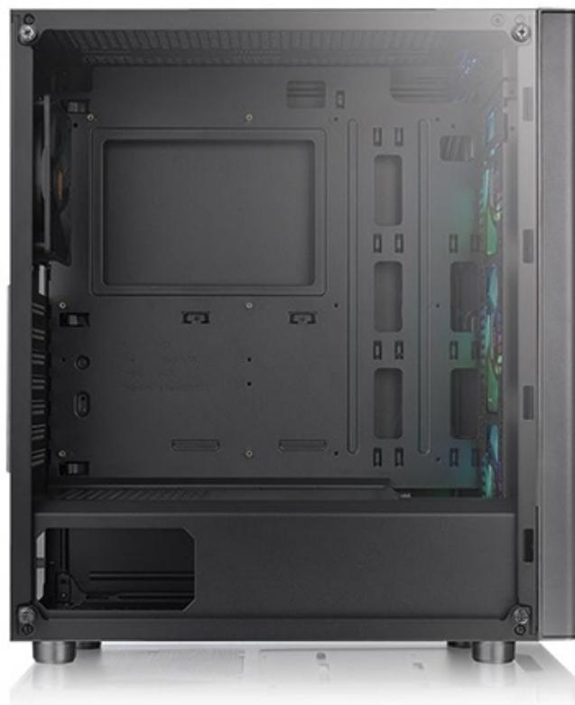
Le schede video installabili non dovranno superare i 320mm in lunghezza e l'alimentatore, che potrà essere lungo al massimo 200mm, andrà posizionato all'interno di un apposito scomparto dove sarà possibile nascondere anche due drive da 2,5" o 3,5" all'interno di un apposito cestello.
