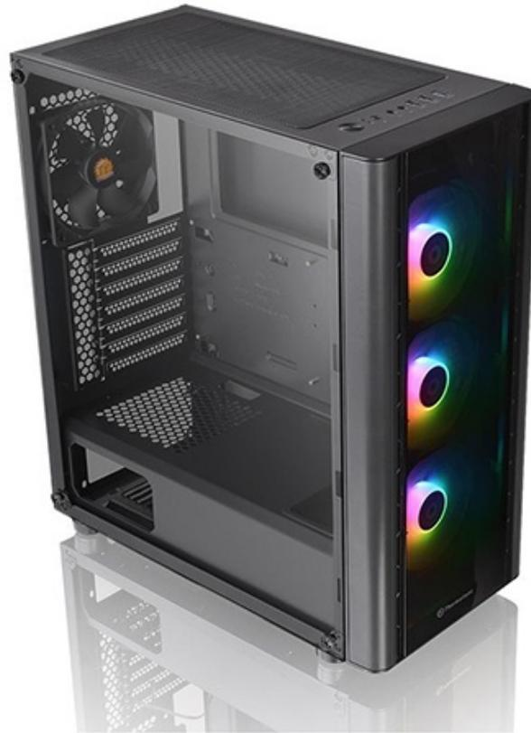
All'occorrenza, tutte le predisposizioni potranno essere affiancate da radiatori facenti parte di sistemi di raffreddamento a liquido custom mentre, coloro che opteranno per un dissipatore ad aria per la CPU, dovranno necessariamente sceglierne uno con altezza inferiore o uguale a 160mm.
