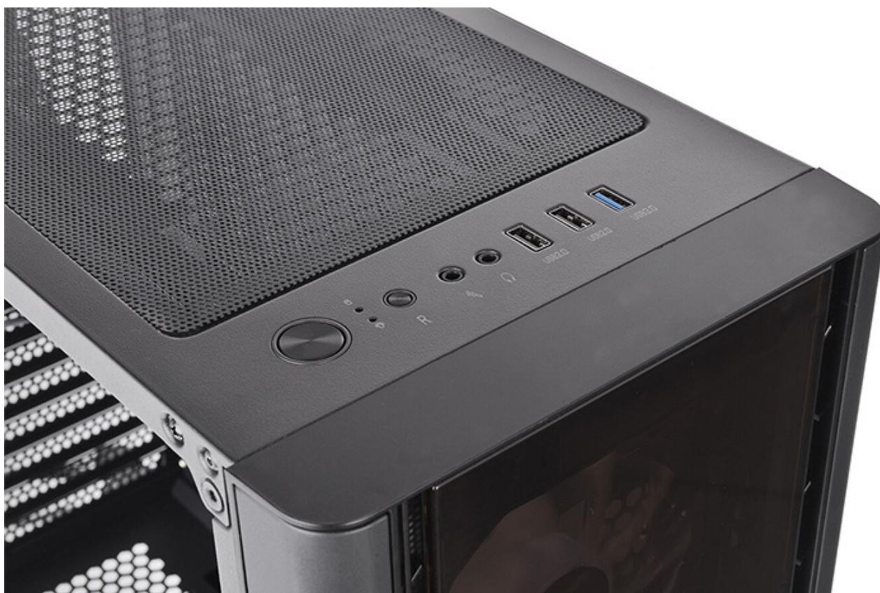
A ricordarci che si tratta di un case "budget friendly" vi è il pannello di I/O composto da due jack HD Audio, due porte USB 2.0 ed una sola USB 3.0.
