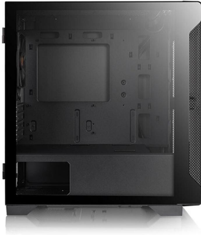
Pur mantenendo le linee pulite della serie S in un formato ridotto ((411x220x441mm), il piccolo S100 garantisce un'ottima versatilità potendo ospitare schede video lunghe 330mm, dissipatori ad aria alti 165mm, due drive da 3,5" più altri due da 2,5" nascosti sul retro del piatto mainboard e sistemi di raffreddamento a liquido avanzati.
