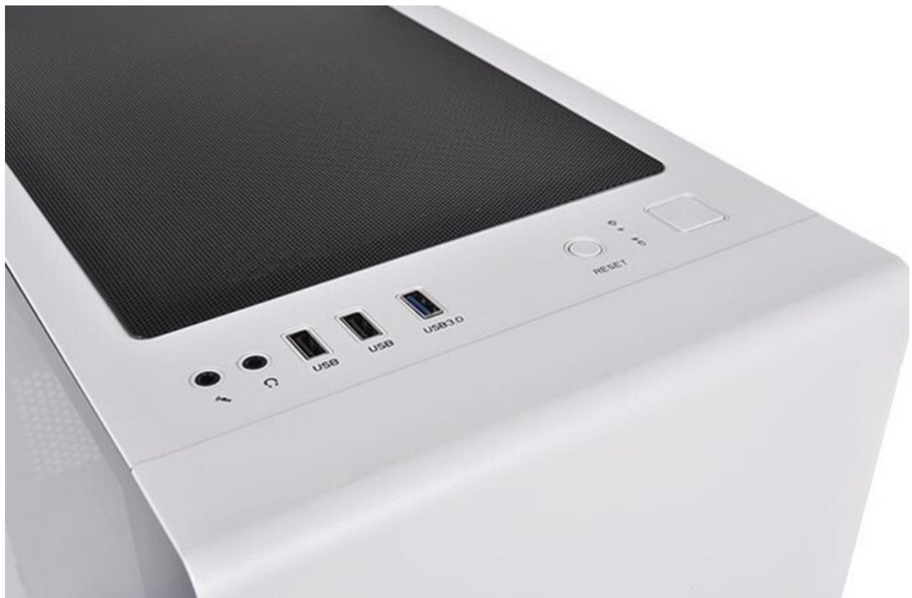
Il pannello di I/O è composto da una USB 3.0, due USB 2.0, due jack HD Audio, i LED di stato ed i pulsanti di power e reset.
