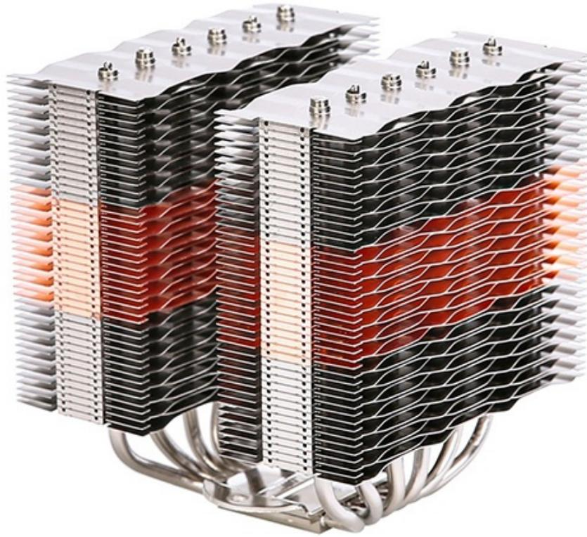
Il fitto corpo dissipante a doppia torre è composto da lamelle "4D Stereoscopic Corrugated Cooling Fin" in alluminio ondulato ed in grado di aumentare di circa il 15% la superficie totale dell'area di scambio, nonché garantire un ottimo flusso di aria anche con ventole a basso regime di rotazione.
