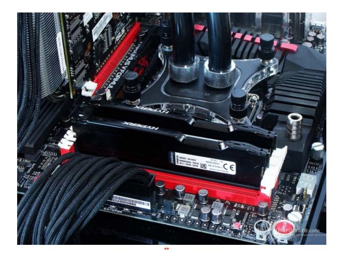
In questa serie di prove ci siamo limitati ad un leggero overclock del sistema, determinando la massima frequenza stabile per la CPU compatibilmente con il sistema di raffreddamento utilizzato, il divisore di memoria più appropriato ed impostando una tensione d'esercizio massima per VDRAM e VCCSA, rispettivamente, di 1,68Volt e 1,25Volt.
