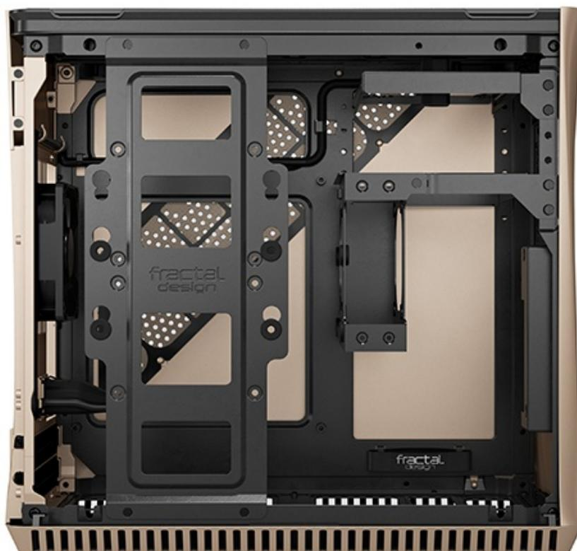
In alternativa, utilizzando un alimentatore ATX, sarà comunque possibile usufruire di una predisposizione per drive da 3,5" utilizzabile anche per due drive da 2,5".
