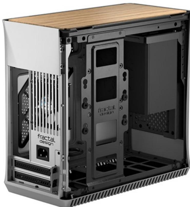
Nonostante le compatte dimensioni, di 325x166x307mm (AxLxP), il case è in grado di contenere ben cinque ventole, di cui una da 80mm inclusa sul retro, più due da 120mm installabili sul top e due da 140mm sul fondo.
