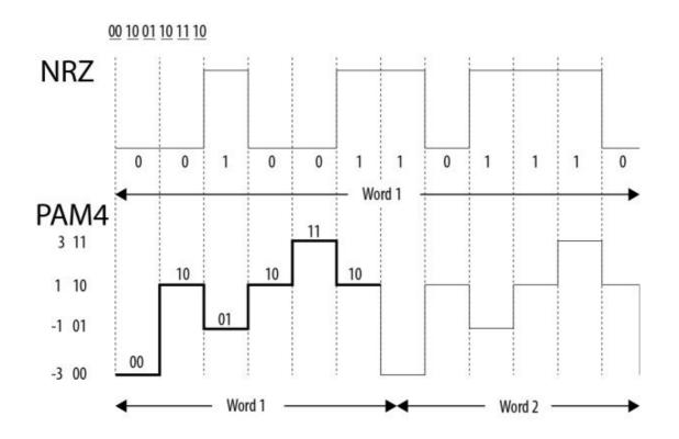
Tali risultati sono ottenuti grazie all'introduzione della tecnologia Pulse Amplitude Modulation con codifica su quattro livelli (PAM-4), che va a soppiantare l'attuale Non-Return-to-Zero (NRZ) su due livelli grazie all'implementazione di una tecnica di correzione degli errori (FEC) per preservare l'integrità dei dati.
